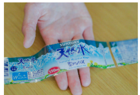
厚さ12μmの国内最薄ロールラベル
