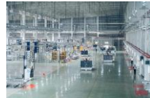
AGV(無人搬送車)による製品の自動搬送
