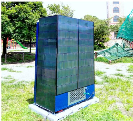
カルコパイライト太陽電池を用いた次世代型太陽光パネルを自動販売機に設置
