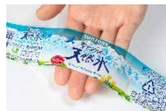
厚さ12μmの国内最薄ロールラベル
