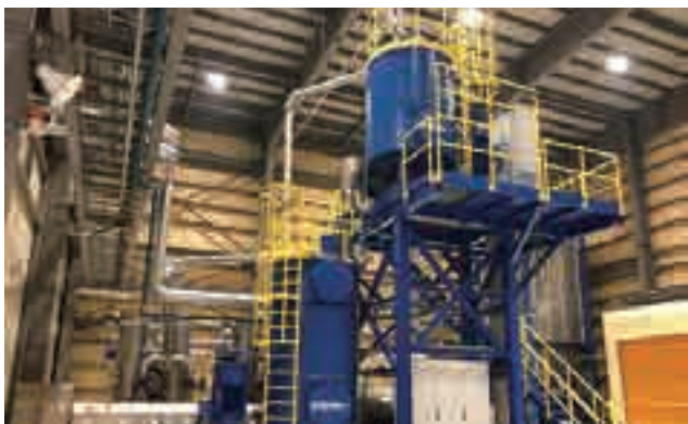
ペットボトルの革新的なりサイクルシステムを開発 協栄産業(株)および海外機械メーカーと協同で「FtoPダイレクトリサイクル技術」を開発。従来システム比25%のCO 2 を削減*しています(ペットボトル用プリフォーム1kg製造にあたり)。 *使用済みペットボトルからプリフォームまでの工程において
